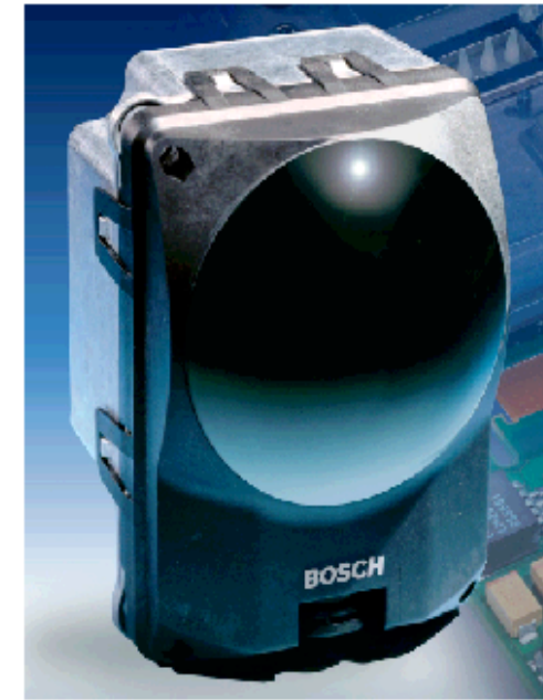
ACC-Radarsensor im One-Box-Design (Fiat Stilo)
