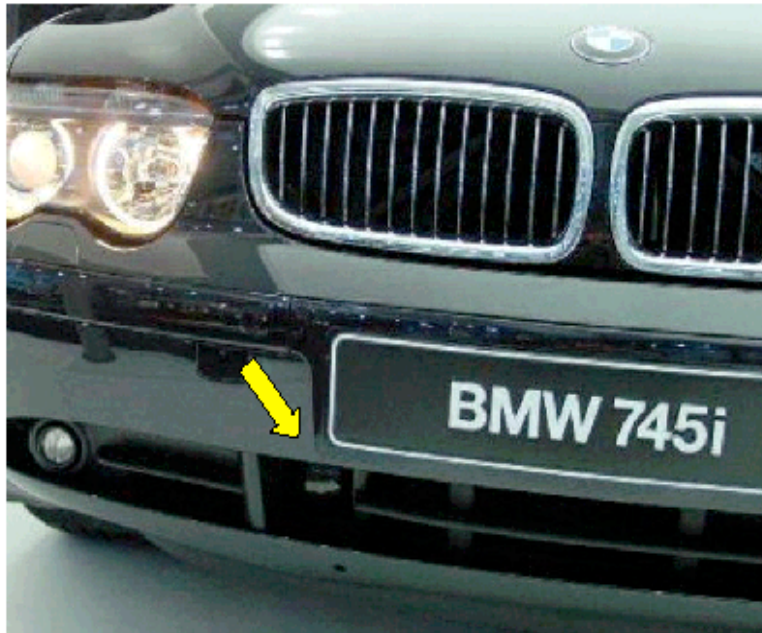
ACC-Sensoreinbau im Stoßfänger (BMW 7er, E65)
